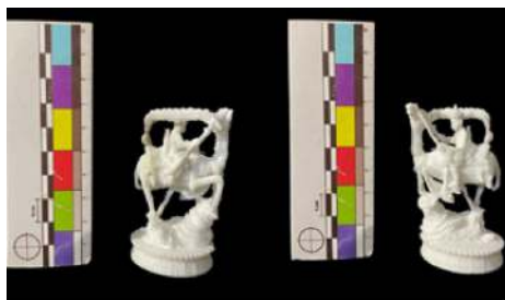
■ شکل ۱۷: نتیجه نهایی نمونه اول چاپ شده بعد از جداسازی ساپورت‌ها و آسیب به بدنه نمونه چاپ شده (مأخذ: نگارندگان).
