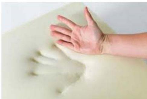
■ شکل ۴: قابلیت فوم هوشمند در فرم‌پذیری و حفظ فرم شیء که روی آن قرار می‌گیرد.
