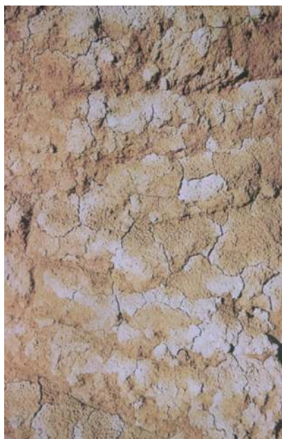
■ شکل ۲۶: ترک‌خوردگی شدید مصالح بر اثر نوسان دما (مأخذ: نگارنده، ۱۳۷۹).
