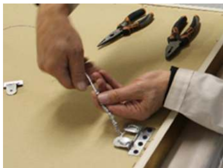
■ شکل ۲۳: نصب مفتول فلزی تابیده در پشت تابلو
