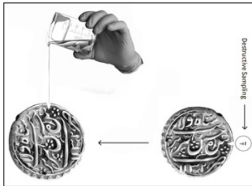
■ تصویر ۲. نمونه‌برداری مخرب از سکه تاریخی و تخریب سکه: آنچه که در این تصویر نشان داده شده این است که بخشی از سکه با اره مویی به عنوان نمونه بریده شده و جای خالی آن با استفاده از رزین اپوکسی پر و سپس موزون‌سازی شده است (نگارنده)
