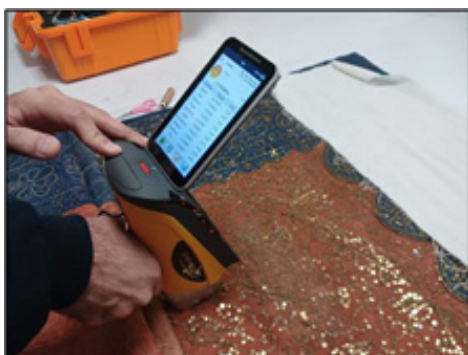
■ تصویر ۵. استفاده از آنالیز غیرمخرب HH-XRF (طیف‌سنجی فلورسانس اشعه ایکس دستی) به منظور بررسی فلزات بکار رفته در تزئین پارچه‌های تاریخی به جای نمونه‌برداری و انتقال نمونه‌ها به آزمایشگاه (نگارنده)
